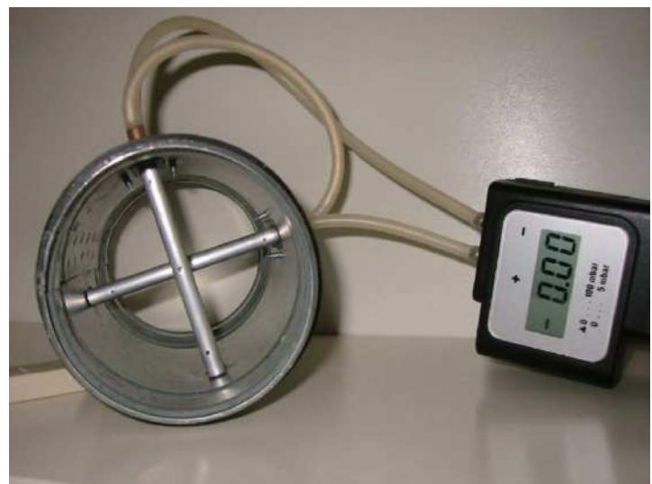
静压十字风速计最好固定安装在系统内并留在那里，这样可以随时检查平衡，必要时进行补调。调节数据应该记录归档。新出来的一些仪器。可以借助风机性能曲线自动调节送风和排风体积流量。
