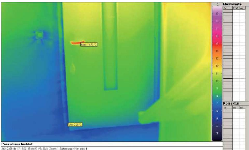
图 5-13：一扇户门和窗户的负压红外成像。可以清晰地看到泄漏点
