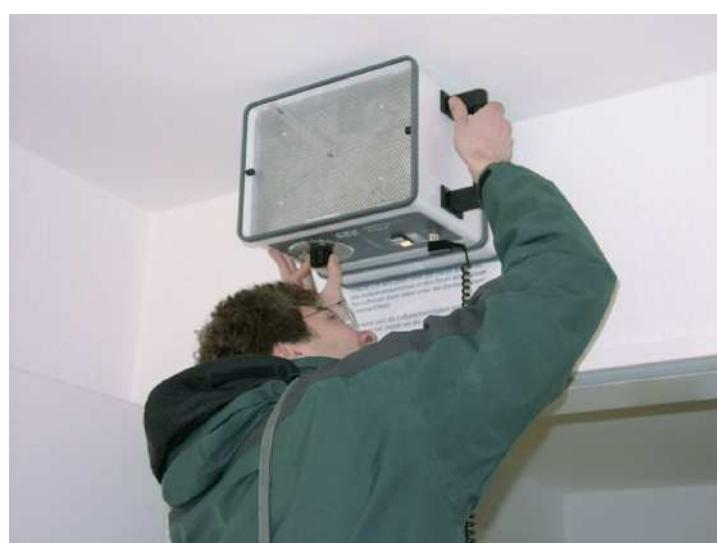
图 5-19：在起居室门上面的送风口上测量新风体积流量
